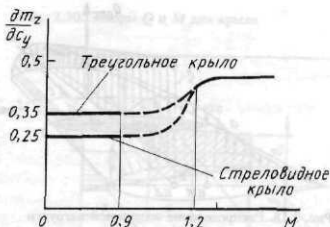
Рис. 2.17. Изменение положения фокуса крыла в зависимости от числа M полета
