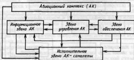
Рис. 1.2. Структура авиационного комплекса
